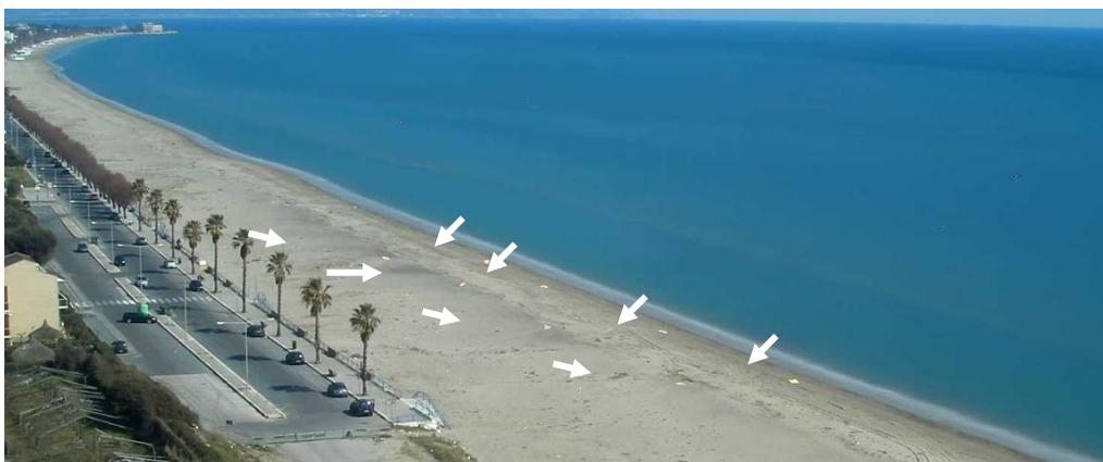
Figura 5. – Particolare della foto scattata in data 18 Febbraio 2009, in cui sono state posizionate delle mire graduate di 1m x 1m, evidenziate dalle frecce.
